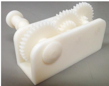
図1 3Dプリンタを用いたロボットのための基礎機械機構の造形
